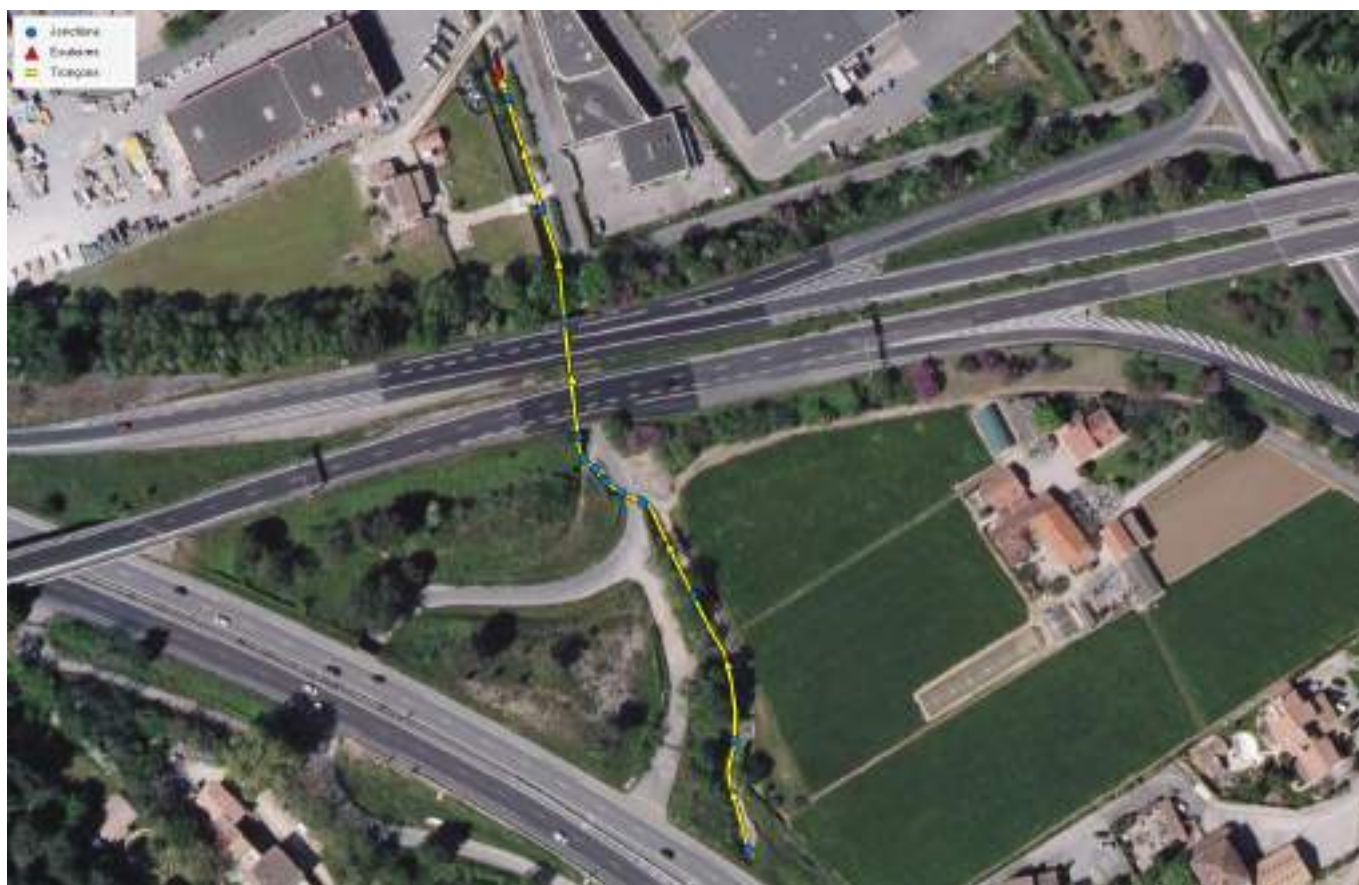
Illustration 6 : Synoptique des sections et ouvrages modélisés - PCSWMM
