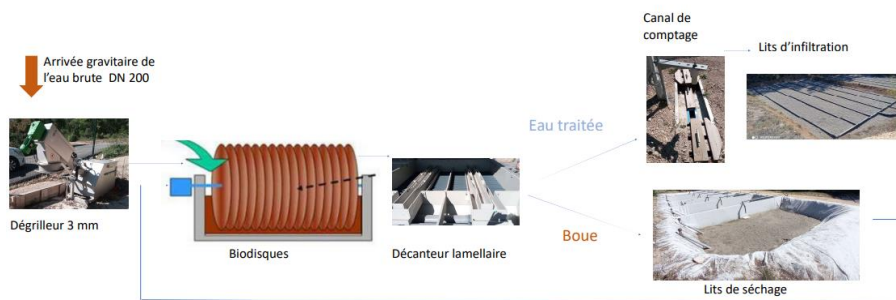
Figure 53 : Synoptique de traitement de la nouvelle STEP du pigeonier basée sur des bioprocédés avancés pour traiter les effluents du Hameau du pigeonier avec une capacité de 350 EH.
